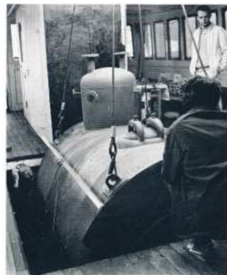
Den nya ångpannan sänks ned i färjans maskinrum. Foto Arad Fischer, Statens Sjöhistoriska Museum.
